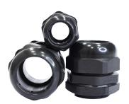
Conectadas nos conduítes flexíveis para aprimorar o acabamento da instalação. Para o acoplamento é necessário soltar a peça de prensagem, encaixar o conduíte na ranhura da terminação e fazer o aperto da peça com a ferramenta apropriada. Esse tipo de terminação é indicado para os casos de montagens sob movimentos ou vibrações constantes.
