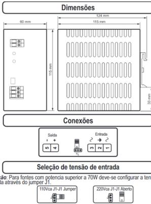
Atenção: Para fontes com potência superior a 70W deve-se configurar a tensão de entrada através do jumper J1.
