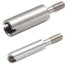
Codificadores e Pino Guia Constituído de elementos: Macho (guia); Fêmea (bucha) . Evita o acoplamento incorreto dos contatos; Recomendado nas tomadas acima de 72 pólos para a simetria de conexão, isto é, os inserts devem estar plenamente alinhados para não entortar e danificar os contatos.
