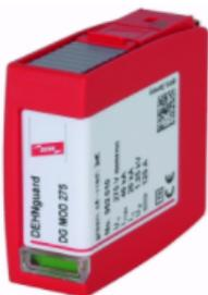
DGMODPV Modulo indicado para utilização em sistemas fotovoltaicos. Contém unidade completa pre-ligada para utilização em string box. É um dispositivo combinado de desconexão e curto-circuito com isolamento elétrico seguro, evitando danos no dispositivo de proteção contra sobretensão em caso de falhas de isolamento no circuito do gerador Produto testado de acordo com EN 50539-11 e adequado para uso em todos os sistemas fotovoltaicos de acordo com IEC 60364-7-712.
