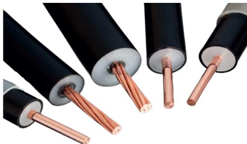
Condutor HVI® Condutor isolado e resistente a alta tensão para manter a distância de separação das partes eletricamente condutoras. De acordo com NBR5419 (IEC 62305-3) Distância de separação equivalente de ? 75 cm (no ar) ou ? 150 cm (material de construção sólido) Atende aos requisitos da DIN IEC / TS 62561-8 (VDE V 0185-561-8) Temperatura de processamento de - 5 a +40 ° C Faixa de temperatura permanente (no caso de instalação fixa) de -30 a +70 ° C
