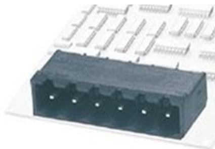
Os Conectores plugáveis da Série EDG são conhecidos por oferecerem uma grande vantagem na manutenção de placas eletrônicas, pois não é necessário a remoção de cabo por cabo, bastando apenas a remoção do plugue fêmea. Os conectores macho, também conhecidos por "HEADER", são fixados diretamente nas Placas de Circuito Impresso e estão disponíveis em diversos passos (ou Pitch).
